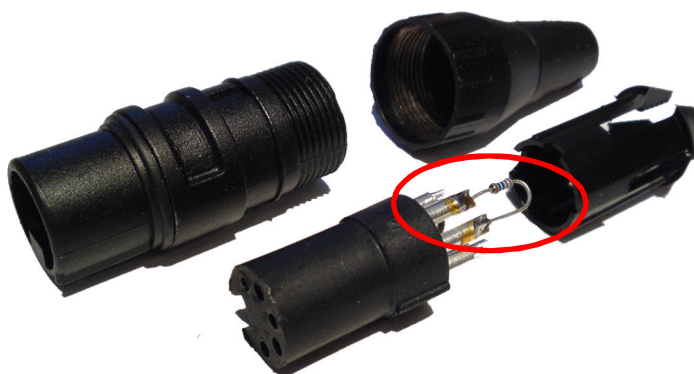
Terminering monterad inne i XLR-5pol kontakt
