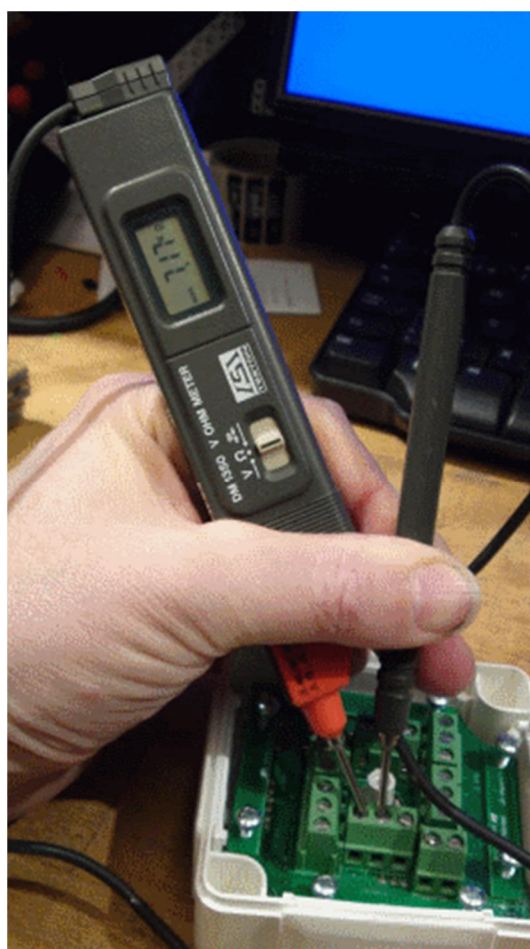
Ej terminerad DMX mottagare, ca 7.1 K \Omega
